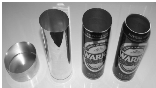
Rys. 3. Puszka „bazowa” podczas kolejnych etapów produkcji Fig. 3. The „base” can during consecutive production steps
