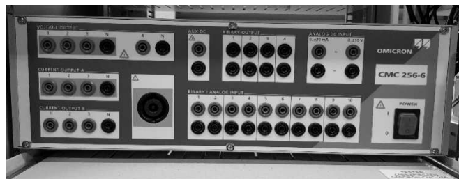
Rys. 4. Tester zabezpieczeń CMC 256-6
