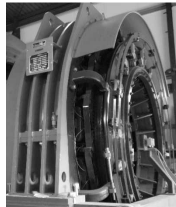
Rys. 1. Silnik wyciągowy serii PW produkcji DFME
