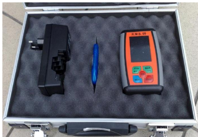
Rys.4. Urządzenie do pomiaru przyspieszeń Merex AMX905 firmy Automex.
