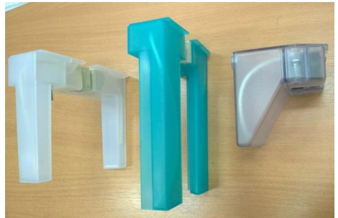
Rys.3. Typowe smarownice olejowe prowadnic dźwigowych.
