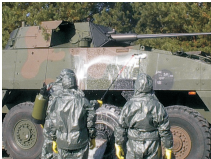
Rys. 6. Nanoszenie emulsji odkaźnika proszkowego z przenośnego przyrządu odkażającego z dyszami spieniającymi potrójnymi
