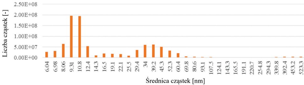
Rys. 6. Rozkład wymiarowy średnic cząstek stałych
