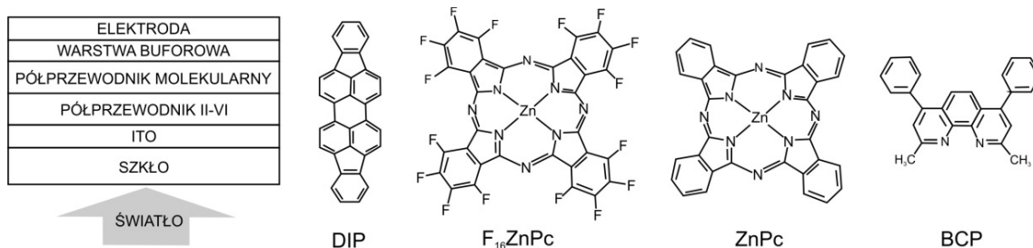
Rys. 2. Struktura badanych układów oraz budowa chemiczna cząsteczek materiałów organicznych wchodzących w skład wytworzonych ogniw
