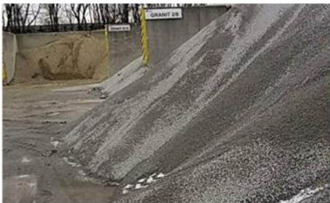
Rys. 19. Zasieki betonowe z kruszywem budowlanym
