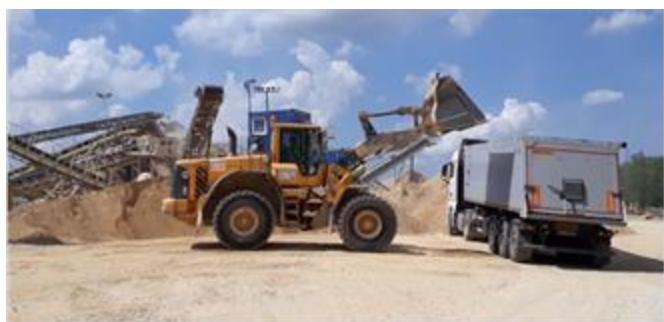
Rys. 14. Załadunek kruszywa budowlanego
