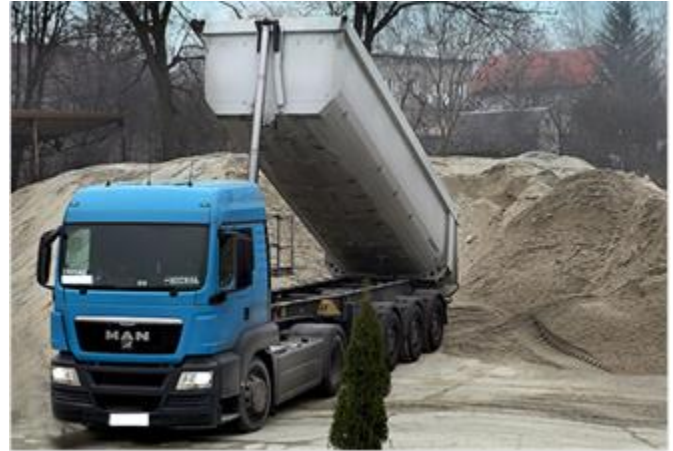
Rys. 20. Rozładunek kruszywa budowlanego
