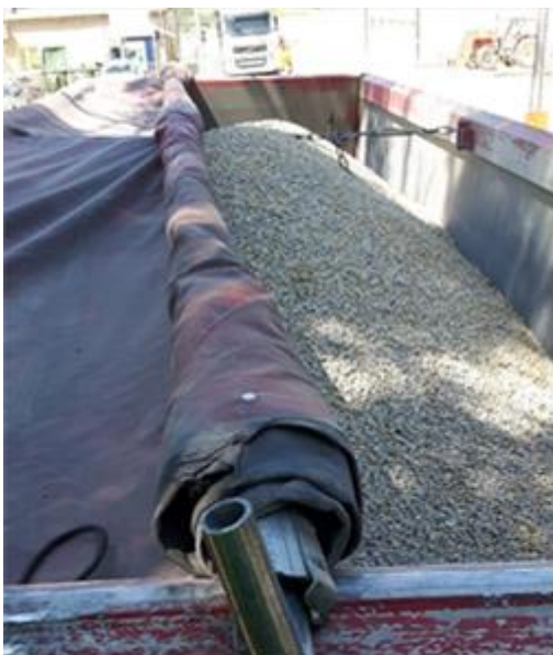
Rys. 18. Plandekowanie skrzyni ładunkowej
