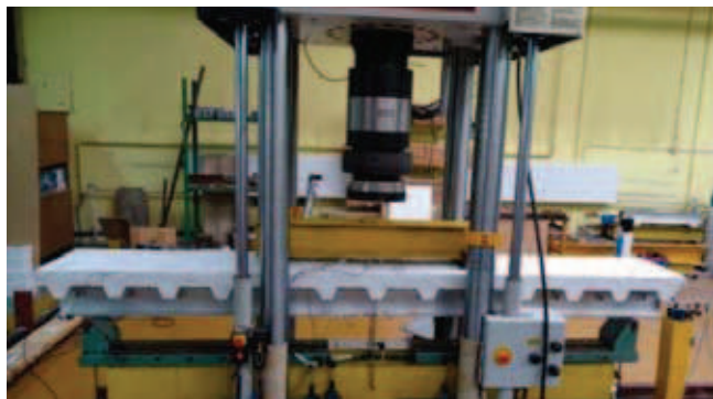
Rys. 1. Belka zespolona aluminiowo-betonowa badana w laboratorium Instytutu Konstrukcji Budowlanych w Poznaniu
