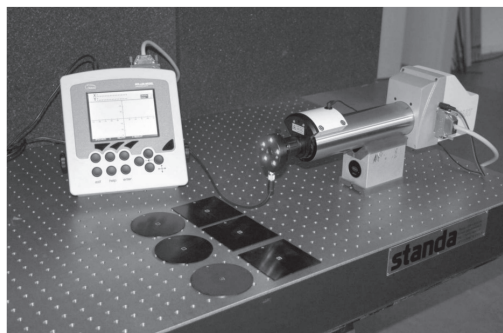
Rys. 5. Przystawka ACenD wraz kompletem przesłon, zamocowana na autokolimatorze ELCOMAT 3000
