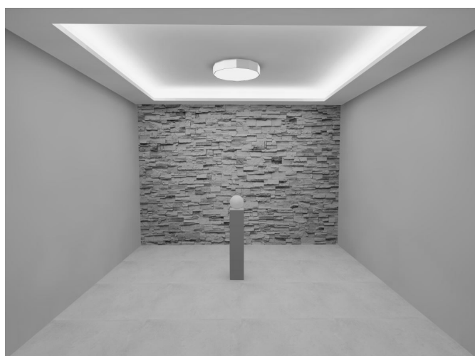
Rys. 3. Oświetlenie wnętrza oprawą sufitową. Podświetlona wnęka
