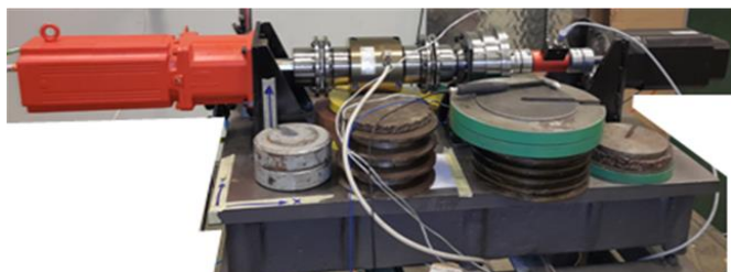
Rys.9. Stanowisko badawcze z dodatkowymi masami
