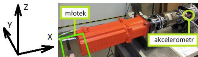
Rys.3. Przykładowe miejsce instalacji akcelometru na wsporniku przekładni cykloidalnej na kierunku X, przy uderzeniu młotkiem modalnym w obudowę silnika w tym samym kierunku X
