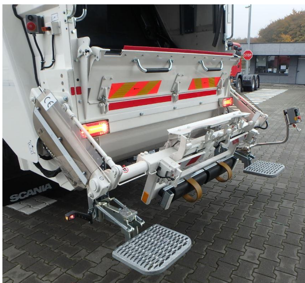
Rys. 2 Wrzutnik typu SK350
