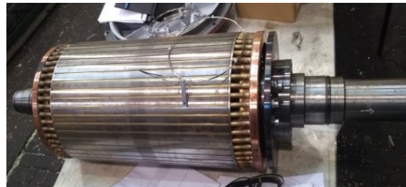
Rys. 3. Widok wirnika do prób zwarciovych [źródło: opracowanie własne]
