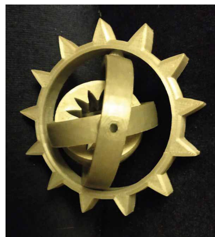
Rys. 1. Wydrukowany w 3D „w jednym rzucie” model astrolabium, którego fragmenty mogą obracać się względem siebie © H. Dodziuk
