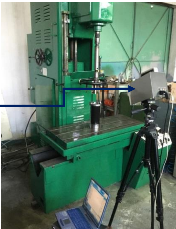
Rys. 24 Stanowisko badawcze: honownica konwencjonalna hydrauliczna z kamerą termograficzną Vigocam (poz.1)
