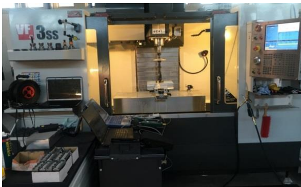
Rys. 13 Frezarka CNC HAAS VF 3SS ze sterowaniem Fanuc z oprzyrządowaniem do gładzenia f-my Honingtec
