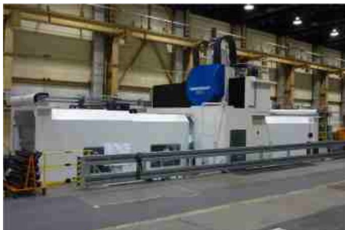
Rys. 3. Centrum obróbkowe z możliwością przemieszczeń roboczych w osiach odpowiednio: X= 14 700, Y = 4 000 i Z = 2 050 mm [4]
