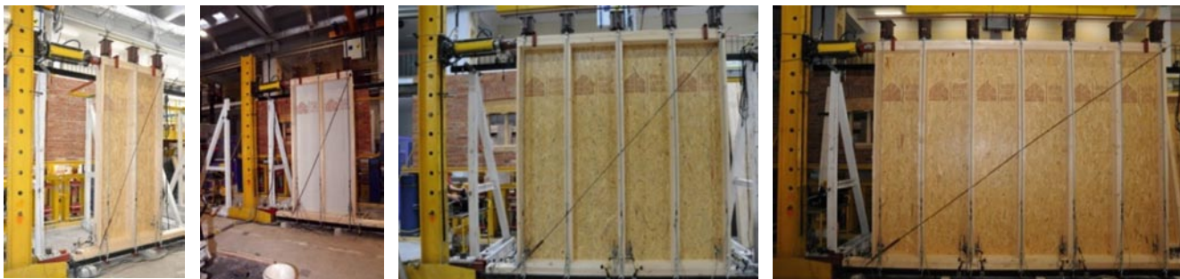
Rys. 4. Widoki wybranych modeli na stanowisku badawczym: (od lewej) pojedynczego modułu pełnego „MP” z poszyciem z płyty OSB, „MP” z poszyciem z płyty gipsowo-włóknowej, układu linowego dwóch modułów, układu linowego trzech modułów
