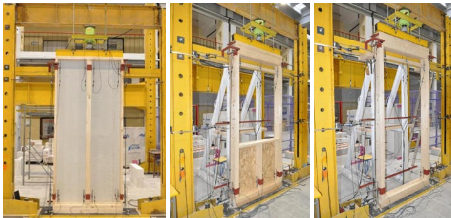
Rys. 3. Widoki modeli na stanowisku badawczym: (od lewej) modułu pełnego „P” z poszyciem płyty gipsowo-włóknowych, modułu okiennego „OK” z poszyciem z płyty OSB i modułu dla okien tarasowych „OD”
