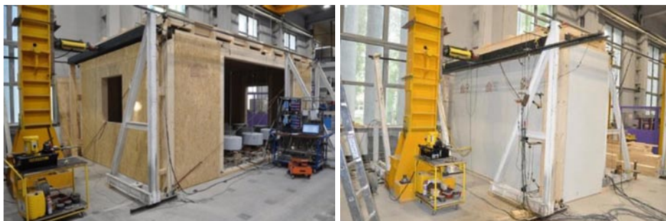
Rys. 4. Widoki wybranych modeli na stanowisku badawczym: (od lewej) pojedynczego modułu pełnego „MP” z poszyciem z płyty OSB, „MP” z poszyciem z płyty gipsowo-włóknowej, układu linowego dwóch modułów, układu linowego trzech modułów
