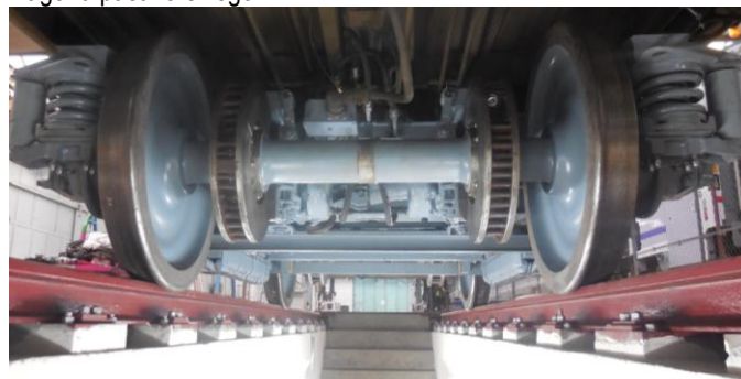
Rys. 2. Widok z kanału rewizyjnego na zestaw kołowy wózka GP200 z tarczami hamulcowymi wagonu pasażerskiego z2AMG-FP
