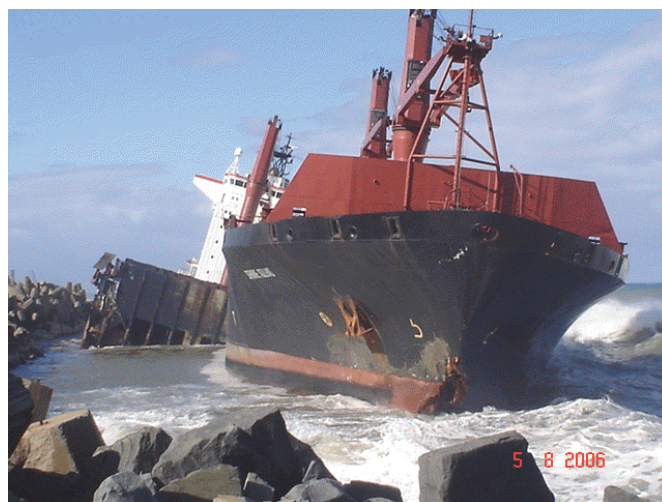
Rys. 4. Mv „Safmarine Agulhas” dziewięć dni później w dwóch częściach po pęknięciu kadłuba [6]
