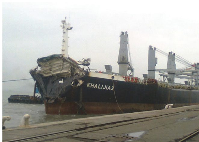
Rys.6. Uszkodzenia statku mv Khalijja 3 [8]
