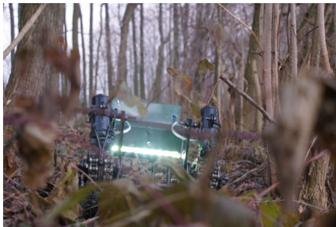
Rys. 11. Test pojazdu w bardzo nieregularnym terenie leśnym
