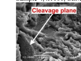
Fig. 24. Al 7075 Sample 5, x2000, SEM
