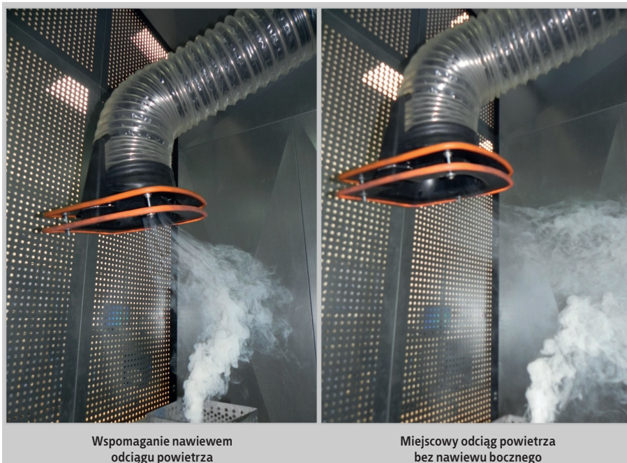
Fot. 3. Wizualizacja przepływu powietrza w dolnej płaszczyźnie głowicy nawiewnika Photo 3. Visualization of the air flow in the lower plane of the ventilator head
