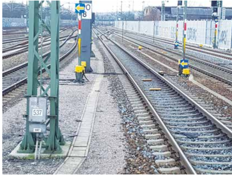
Balisy systemu ETCS i wskaźniki przytorowe na stacji Erfurt (24.02.2017). Fot. A. Massel
