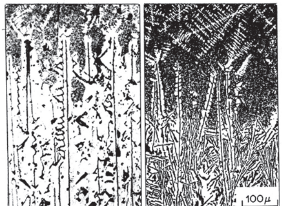
Rys. 17. Struktura włóknista nieregularna; a/ schemat struktury uwzględniający istnienie obszarów regularnych, gdzie istnieje wyprzedzenie fazowe d oraz ze skrajnie zdestabilizowanym frontem gdzie istnieje wyprzedzenie fazowe nadmiarowe d_e ; dla uproszczenia pominięto rozgałęzienia włókien fazy wiodącej, b/ wyprzedzenie fazowe nadmiarowe d_e widoczne w zamrożonej eutektyce Al-Si
