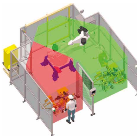
Rys. 11. Monitorowanie obszaru pracy systemem Cubic-S firmy Kawasaki (praca robota dozwolona w strefie zielonej, zabroniona w strefie czerwonej) (Źródło: ASTOR)
