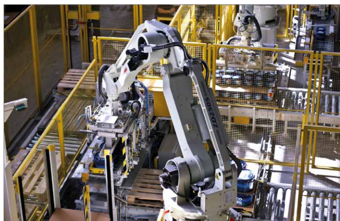
Rys. 8. Stanowisko z robotem Kawasaki ZD250 do paletyzacji wiader z farbą w Fabryce Farb i Lakierów Śnieżka SA w Lubzinie (Źródło: ASTOR)
