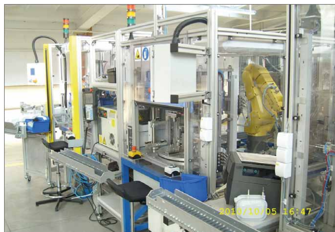
Rys. 9. Montaż instrumentu pomiarowego gazomierza w Aparator Metrix SA (Źródło: FANUC)
