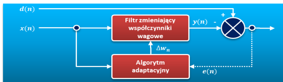
Rys. 10. Ogólny ideowy schemat blokowy filtru adaptacyjnego RLS wykorzystanego w algorytmie przetwarzania obrazu
