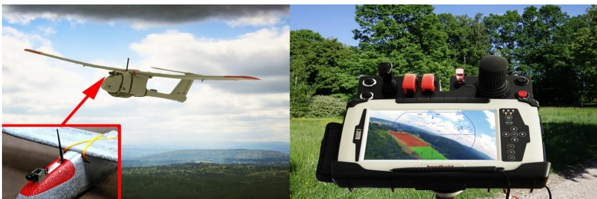
Rys. 5. Proponowana koncepcja w zastosowaniu do BSP; kamera obserwacyjna na BSP (z lewej) oraz widok konsoli operatora (opracowanie własne)
