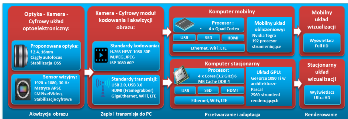
Rys. 6. Schemat struktury sprzętowej proponowanego rozwiązania
