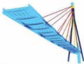
Rys. 15. Kładka nad ul. Wołoską zaprojektowana przez Transprojekt Gdańsk; modele numeryczne MES SOFiStiK
