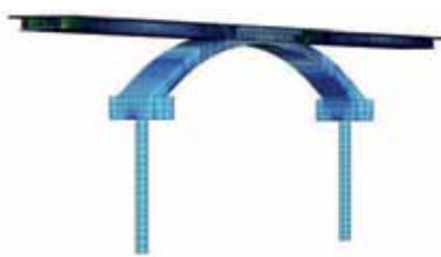
Rys. 17. Most Zamkowy przez San w Rzeszowie zaprojektowany przez Promost Consulting; model MES SOFiSTiK
