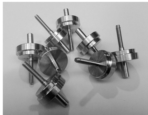
Rys. 4. Piny stosowane do mocowania
