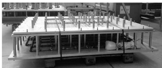
Rys. 2. Forma do produkcji wkładki do bagażnika
