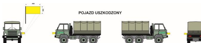
Rys. 9. Sposób oznakowania uszkodzonego pojazdu kolumny wojskowej
