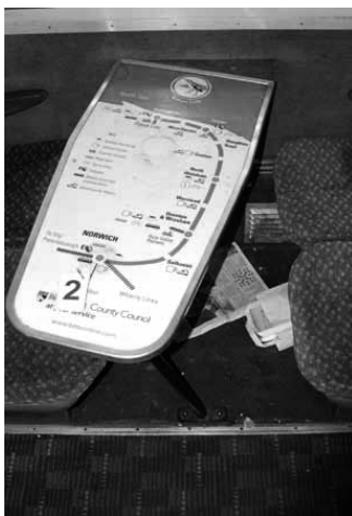
Fig. 1. Typical example of table deformation Rys. 1. Typowy przykład odkształcenia stołu
