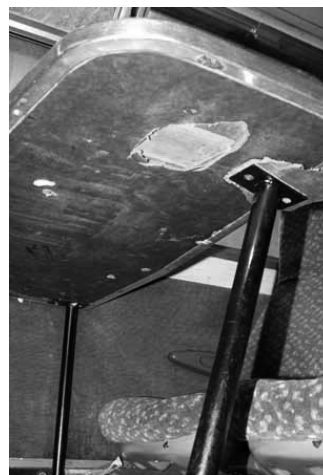
Fig. 2. Typical example of table detachment Rys. 2. Typowy przykład oderwania stołu
