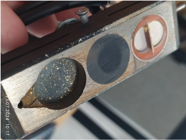
Rys. 10. Testowy blok głowic z rozdzielonym przetwornikiem 0°, pomiarem grubości filmu sprzęgającego oraz kanałem i zbiornikiem cieczy sprzęgającej
