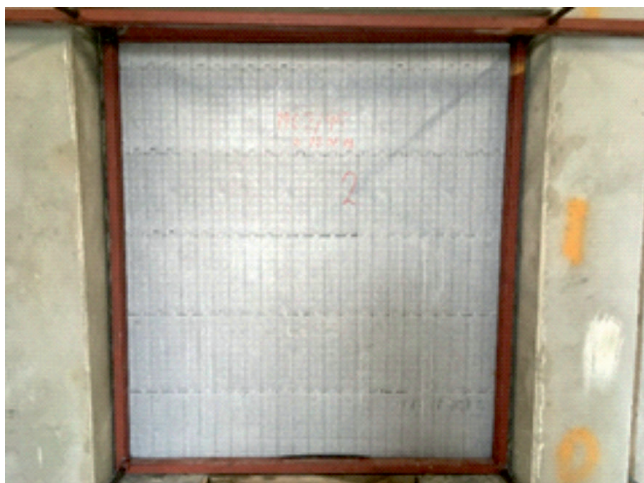
Rys. 3. Ściany z pustaków podczas badań w komorze pogłosowej (widok od strony komory nadawczej)
