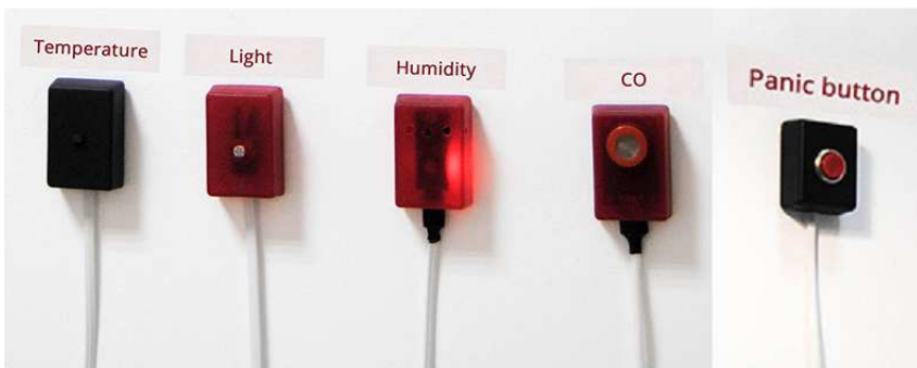
Zdj. 2. Wybrane czujniki i sensory założone w pokoju pokazowym
