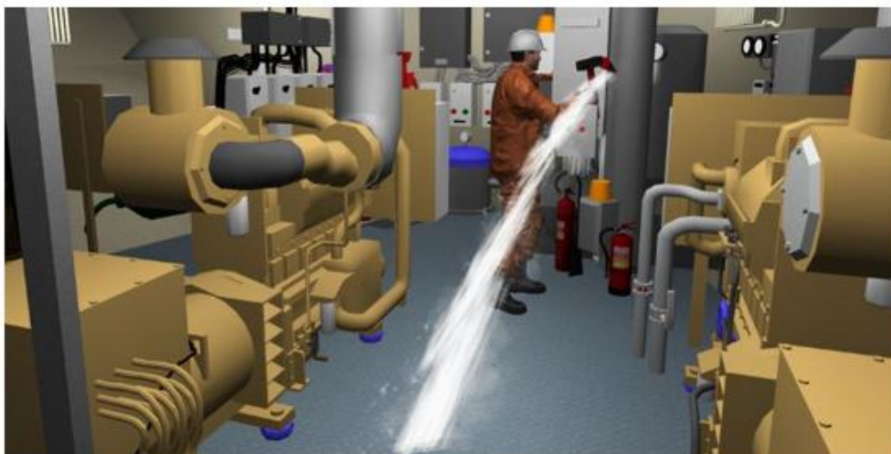
Rys. 10. Awaria rurociągu wodnego na okręcie Źródło: Opracowanie własne. Autocomp Management Sp. z o.o.
