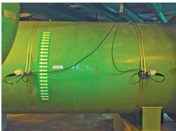
Rys. 1. Przepływomierz ultradźwiękowy: po lewej – głowice przepływomierza, po prawej – jednostka centralna
