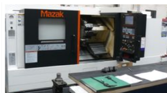
Rys. 7. Centrum NC z napędzanymi narzędziami i programowaniem Mazatrol
