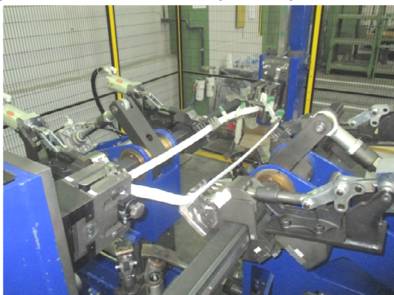
Rys. 9. Rozciąganie cewek stojana
