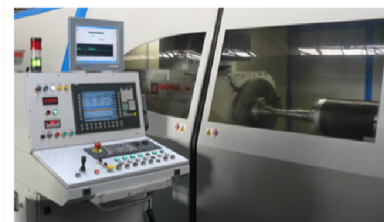
Rys. 8. Szlifowanie stopni wału na wirniku z pomiarem Marposs.
