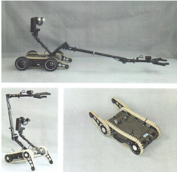
Fig. 1. PIAP SCOUT ® , a small reconnaissance robot
