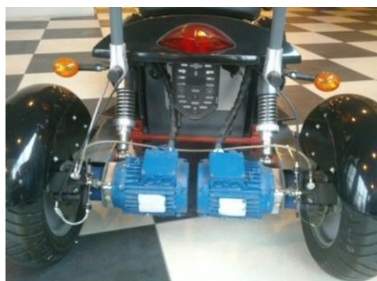
Rys. 7. Mały pojazd elektryczny PeT – u góry: widok z przodu; u dołu: widok silników napędzających tylne koła pojazdu
