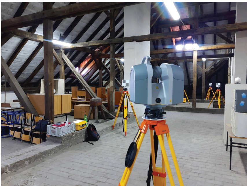
Rys. 1. Stanowisko pomiarowe dla skanera laserowego
