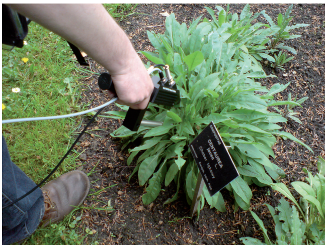
Ryc. 3. Pomiar krzywych spektralnych przy użyciu spektrometrii ASD oraz akcesoria Leaf Clip dołączonego do Plant Probe Fig. 3. Data acquisition using ASD FieldSpec, ASD Plant Probe with Leaf Clip
