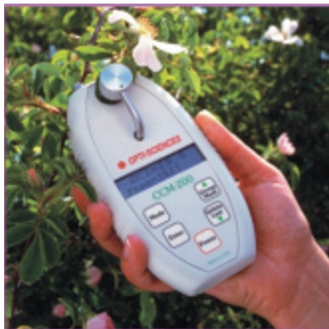
Ryc. 4. Miernik zawartości chlorofilu CCM-200 (Chlorophyll Content Meter) (Źródło: http://www.optisci.com/ccm.htm ) Fig. 4. Chlorophyll Content Meter CCM-200 (Source: http://www.optisci.com/ccm.htm )
