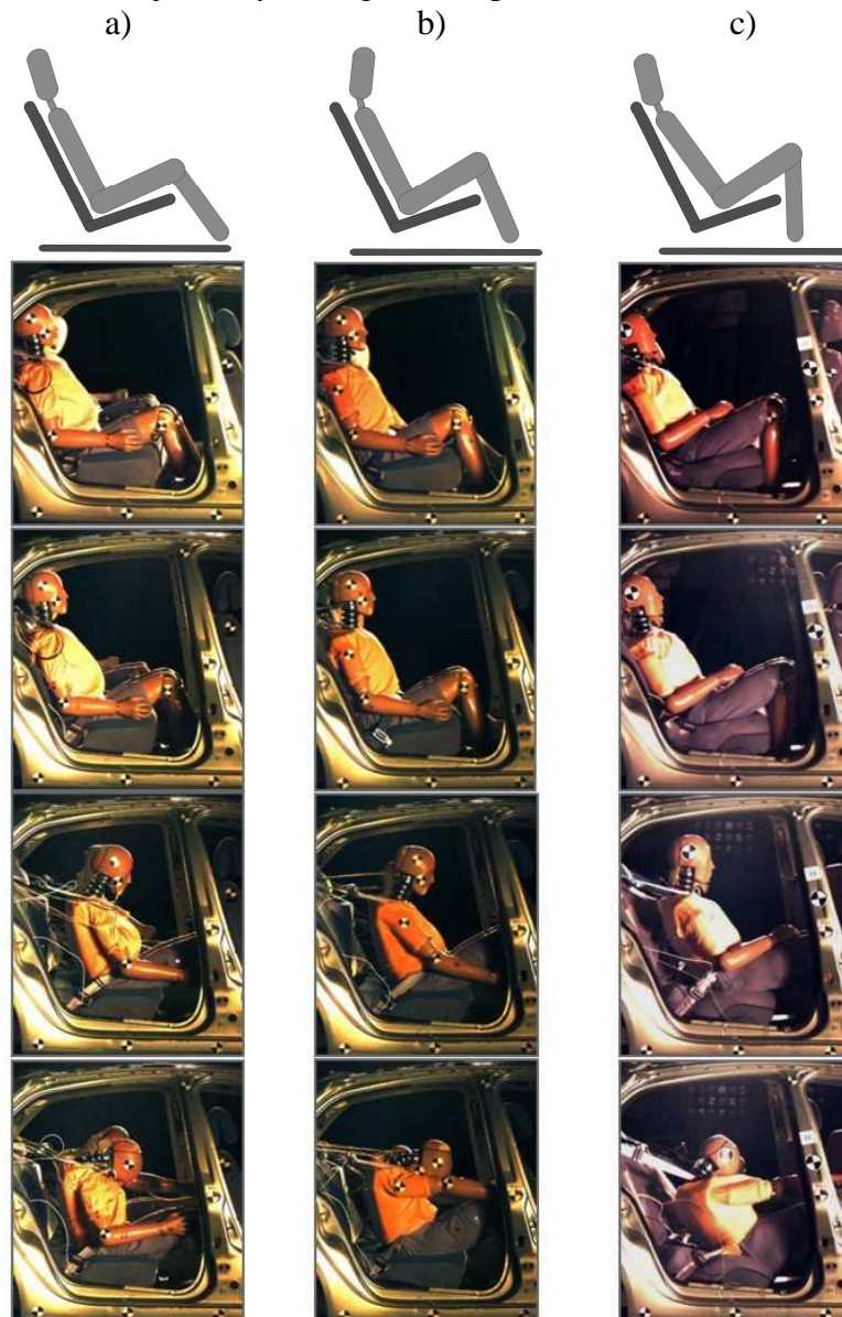
Rys.1. Schemat pozycji początkowej manekina i jego widok w testach 2P (a), 3P (b) i 11P (c) w czasie t=0 ms, 40 ms, 80 ms i 120 ms
