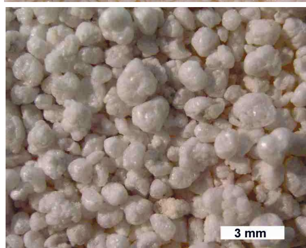
Rys. 2. Zdjęcia perlitu pod klasycznym mikroskopem powiększone 50×: u góry – kl. I, na dole – kl. III Fig. 2. 50 × Microscope magnification of perlite of class I (up) and class III (down)
