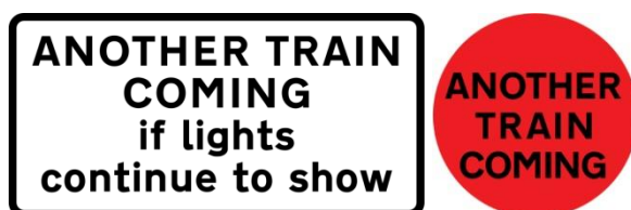
Rys. 3 Tablica i sygnalizator drogowy ostrzegające o możliwości pojawienia się drugiego pociągu na przejeździe w Wielkiej Brytanii [15], [16]
