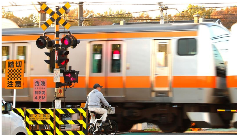
Rys. 5. Japonia – przy sygnalizatorach przejazdowych znajdują zastosowanie strzałki kierunkowe. Na zdjęciu pociągi jadą w obu kierunkach. [18]
