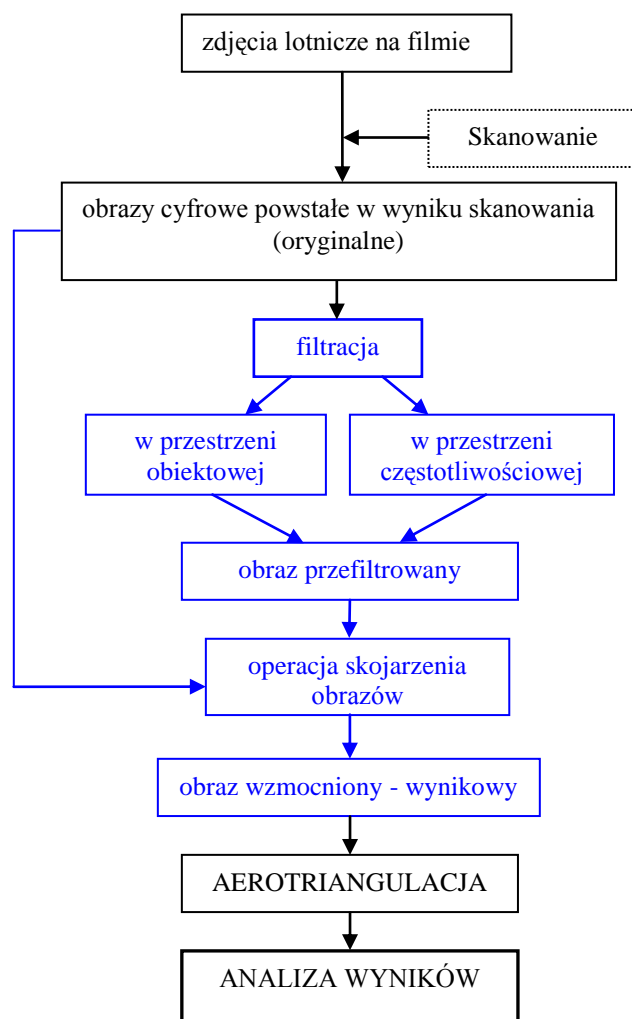
Rys. 1. Schemat postępowania w procesie aerotriangulacji przy filtracji zdjęć lotniczych.
