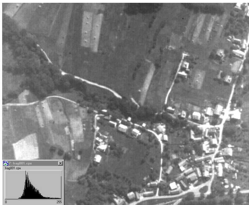
Rys.6. Skojarczenie obrazu oryginalnego z obrazem przefiltrowanym filtrem górnoprzepustowym w przestrzeni Fouriera (przez dodanie obrazów)
