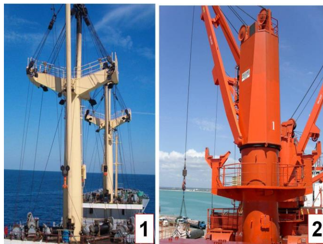
Rys. 6. 1. Boma ładunkowa, 2. Żuraw pokładowy [7]
