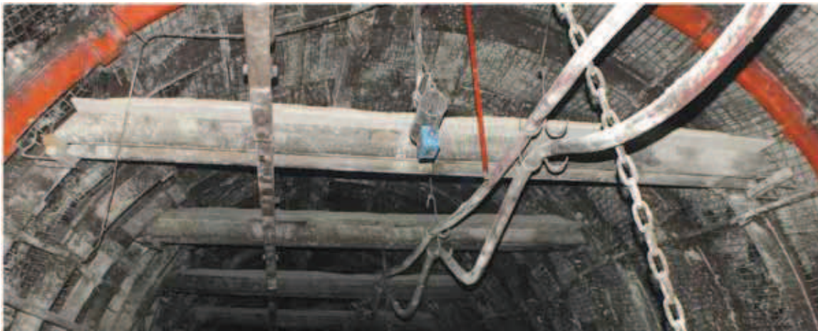
Rys. 1. Zapora przeciwwybuchowa pyłowa w wyrobisku górniczym
