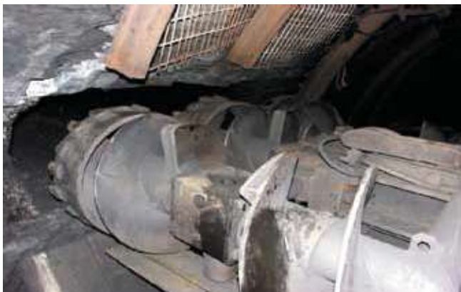
Rys. 2. Widok głowic zwiercających przy ociosie węglowym Fig. 2. View of drilling heads by the coal sidewall
