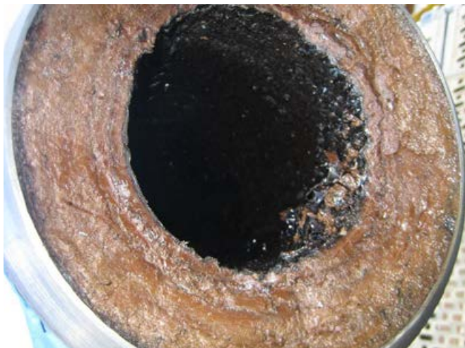
Ryc. 6. Przykład wytrącania się osadów w rurociągu odprowadzającym solankę do otworu zrzutowego (Reed, Greene 2012).
