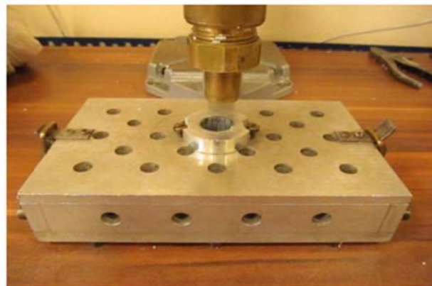
Rys. 2. Metalowa matryca ze stopu aluminium wykorzystana do kształtowania modeli styropianowych
